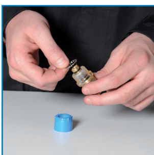
4) Заменить зажим, поставив его на то же место и закрутить крышку. Если зажим поврежден во время разборки, рекомендуется его замена.
