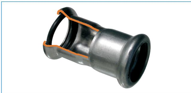
В пресс-фитингах есть карман, в который до упора вставляются концы трубы. Прессовочная машина оснащена обжимными челюстями профиля М с соответствующим размером, который деформирует контролируемым образом конец фитинга на трубе, предотвращая скольжение и провороты в работе под давлением.
